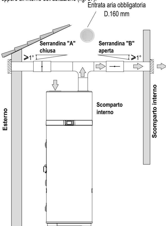
fig. 57- Esempio di installazione nel periodo estivo
