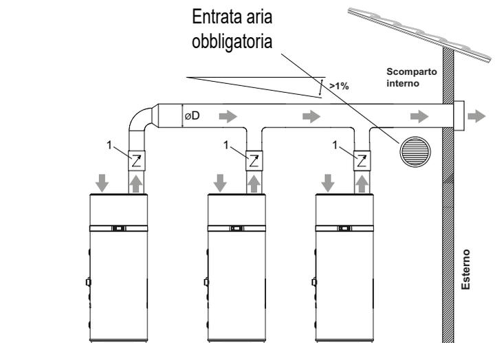
fig. 55 - Esempio di collegamento scarico aria
