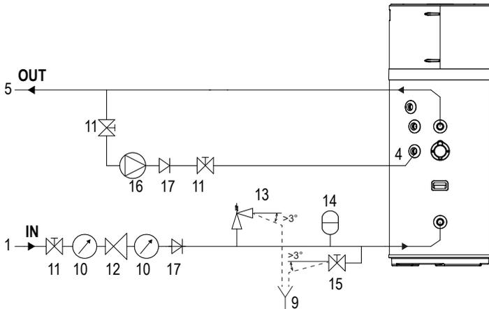
fig. 60 - Esempio impianto idrico SENZA valvola miscelatrice termostatica
