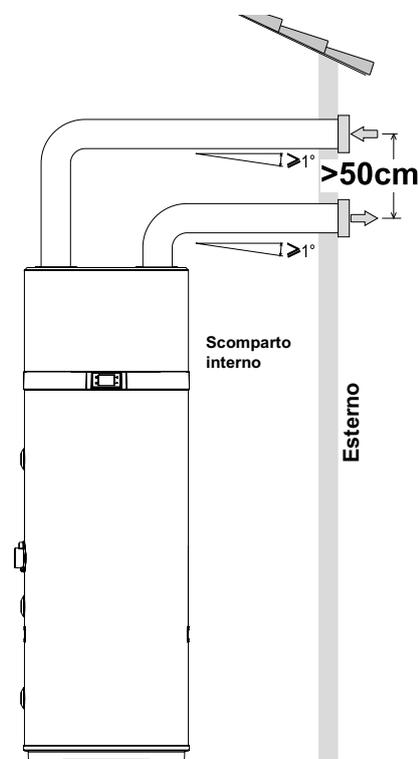
fig. 54- Esempio di collegamento di uscita aria
