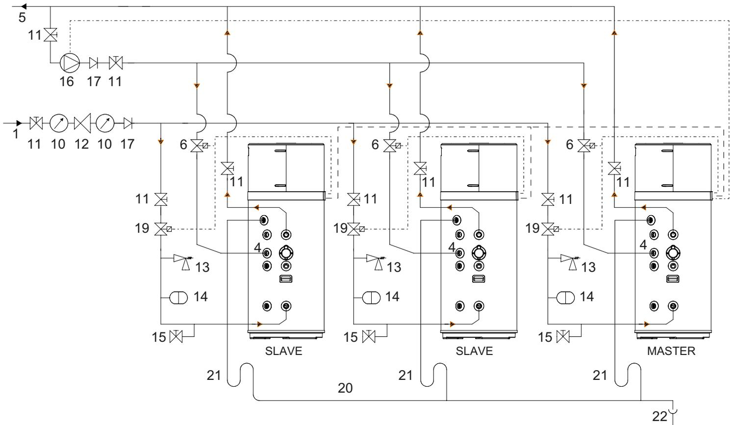
fig. 63 - Esempio impianto idrico SENZA valvola miscelatrice termostatica
