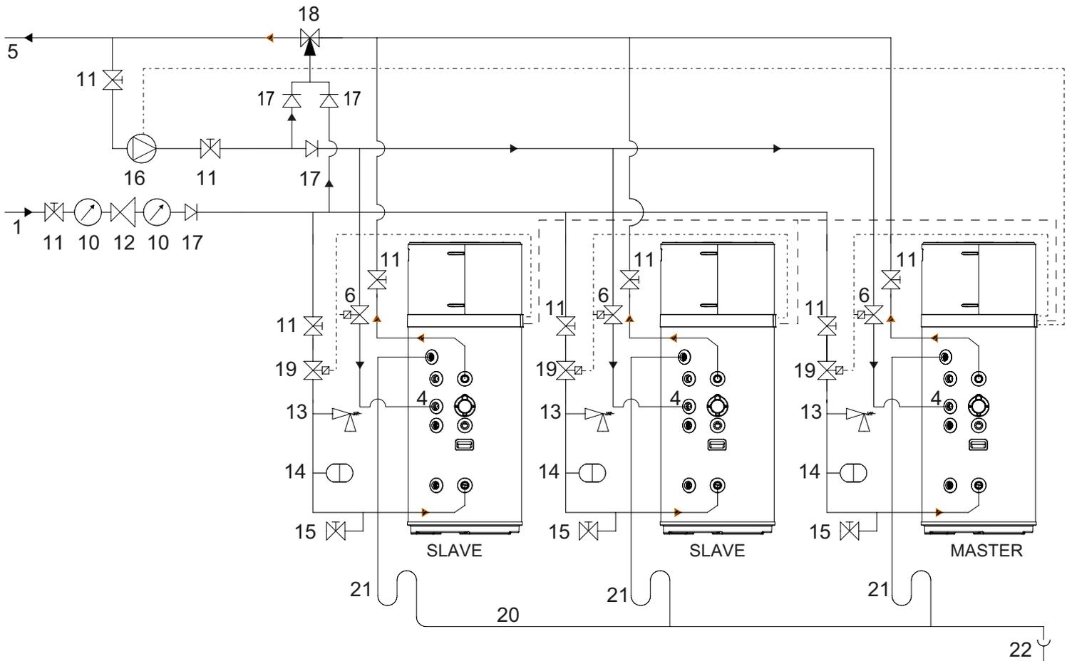
**fig. 65 - Esempio impianto idrico CON valvola miscelatrice termostatica (ricircolo su connessione ricircolo acqua unità)**
