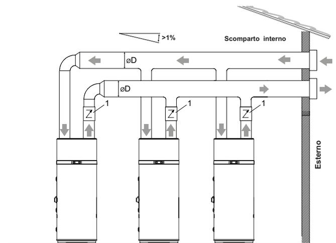
fig. 56- Esempio di collegamento di uscita aria
