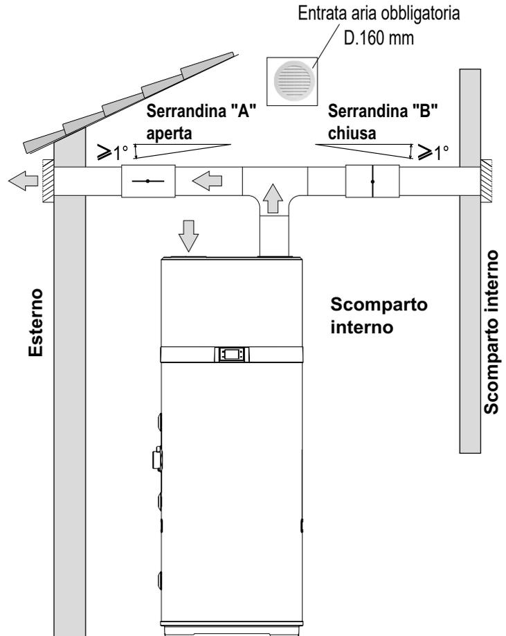
fig. 58- Esempio di installazione nel periodo invernale
