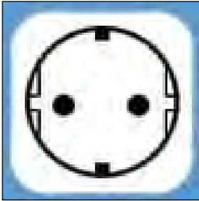
fig. 69 - Schuko socket
